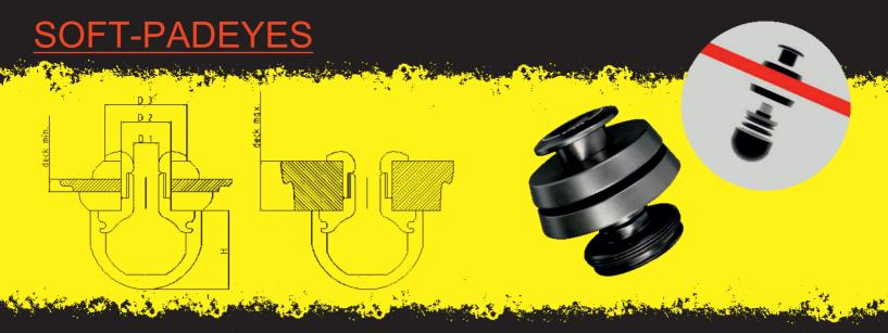
In den Beschlag der Soft-Padeyes DL wird ein vorgereckter Diamond-Loop Dyneema® SK 78 eingehängt, der die Zugkraft über die unter Deck liegende Beschlagseite ins Deck leitet.
