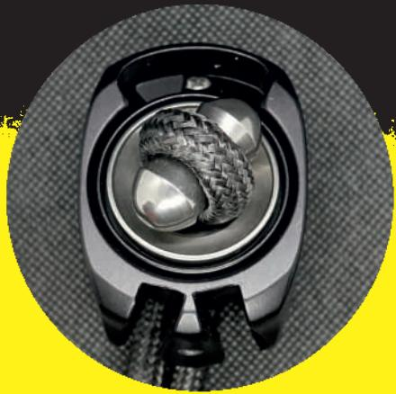
TyeTec® CLD Dogbones wurden speziell für die Verwendung mit TyeTec® padeyes Typ „DL“ und „DF“ entworfen. Ihre Form ist dem Innenradius des Padeyes angepasst um die Kraft sicher einzuleiten. Die Einschnürung in der Mitte hält den Dogbone sicher an seinem Platz. Für manche Anwendungen kann es sinnvoll sein, den Dogbone mit ein paar Stichen und einem Takling zu sichern.
